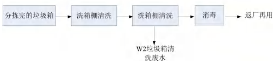
图 2.1-2 垃圾箱清洗工艺流程图及产污节点图
